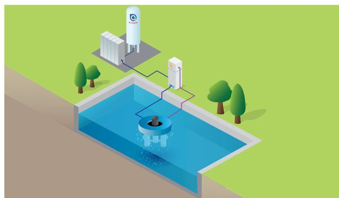
Une des versions du système **INJECTEUR D'OXYGÈNE-TURBOXAL®** est capable d'aspirer l'air ou l'off-gaz en sortie d'ozoneur (faible pression).
